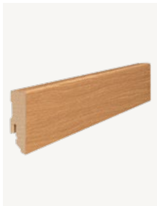
Kubus-Stecksockelleiste Fichte/ Kiefer furniert, Eiche naturel lackiert, L 2.500 x B 58 x S 16 mm
