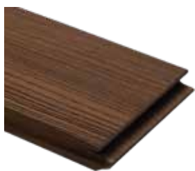
Thermo-Esche, Kopfseiten Nut und Feder, seitliche Rund- hohlkehle (für TENI- Clip), L 1.500/1.800/2.100 x B 112 x S 20 mm
