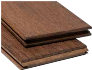
Bambus mineralveredelt , fein genutet/glatt, vorgeölt, stirnseitig Nut & Feder, L 1.850 x B 137/178 x S 20 mm
