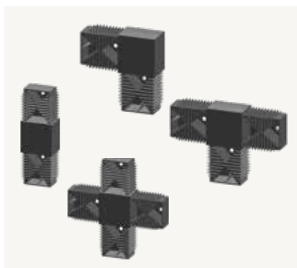
Verschiedene Verbinder System 40 / 60, Farbe: Schwarz, Materialstärke: 2,5 mm, Material: Kunststoff
