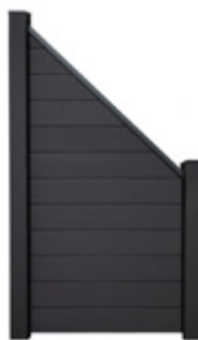
Schrägelement Dunkelgrau, monoextrudiert, Maße: B 1.800 x H 1.800/900 x S 19 mm
